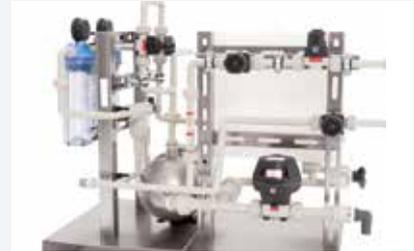
*Tuberías fijas y seguras mediante soldadura IR*
