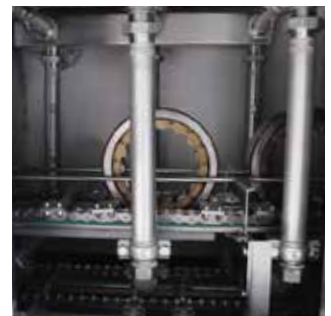
YukonDA Equipo de flujo continuo con transporte vertical de los cojinetes
