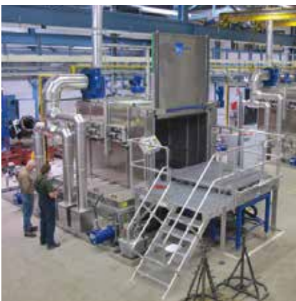
Tanques calefaccionados a gas con plataforma de trabajo
