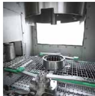
YukonDA Equipo de flujo continuo con sistema de lanza y transporte horizontal
