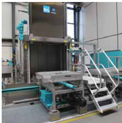
Inserción hidráulica con estación de desplazamiento transversal
