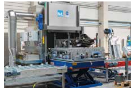
Plataforma elevadora de tijera hidráulica con inserción neumática y sistema de cinta transportadora de rodillos
