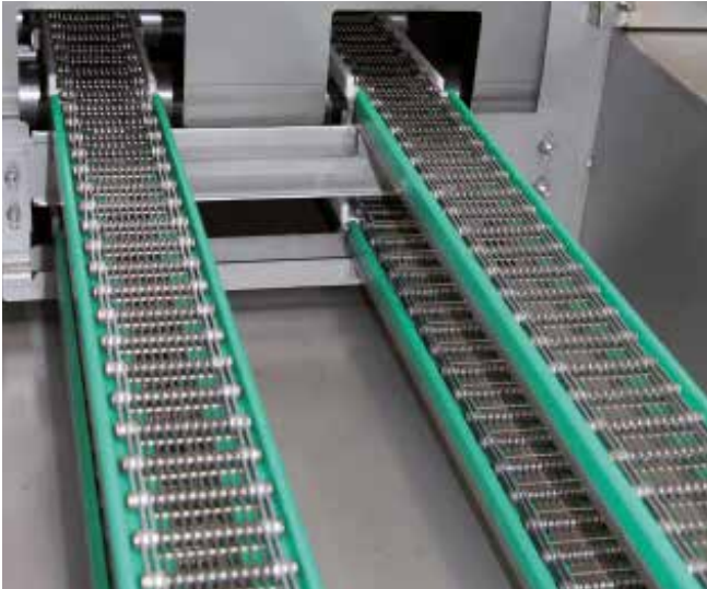
Cinta transportadora de alambre de dos carriles para piezas diferentes, más pequeñas
