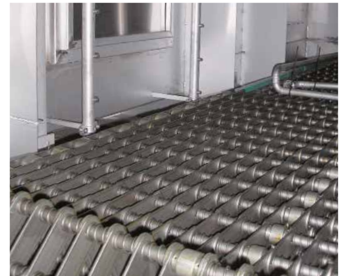
Transportadores de lamas para cargas útiles elevadas
