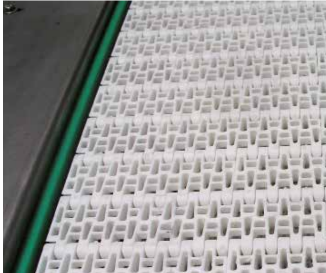
Transportador de plástico para piezas con superficies sensibles
