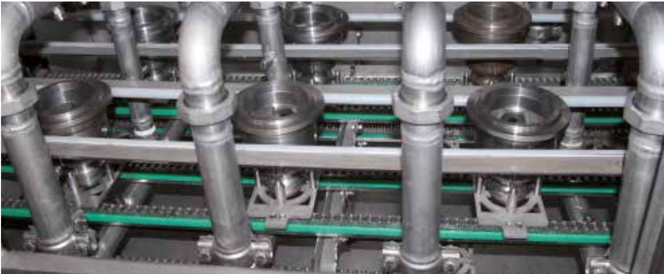
Transportador de cadena con portaherramientas enroscados y sistema de boquillas adaptado
