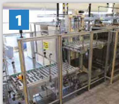
1 Detalle Estación de elevación y descenso
