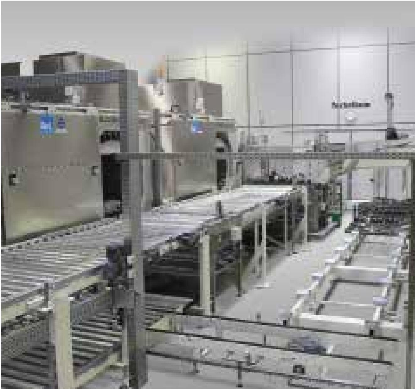
NiagaraDFS como equipo doble con secado Nevada, cinta transportadora de rodillos, cargador de portal y estación portapiezas
