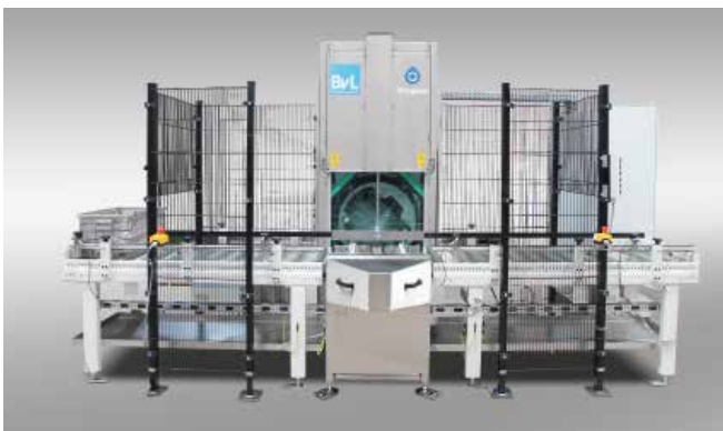
NiagaraDFS con carga y descarga automáticas, incluido el amortiguador de cestas
